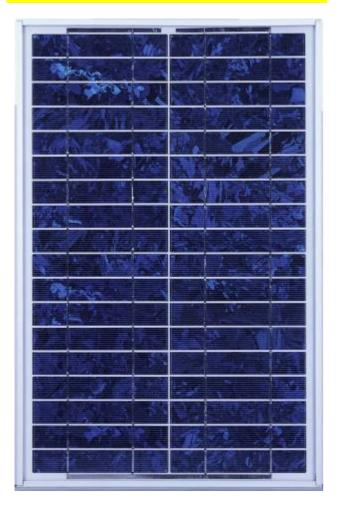
6インチ多結晶シリコン太陽電池素子1/6分割セルを 高信頼インターコネクタ複接続によって36枚直列接続 した太陽電池モジュールです。交通標識や小型無線、 LED表示装置等、各種応用商品の電源に適用します。 青色系多結晶シリコンを採用。
